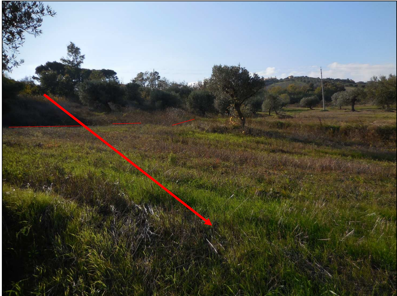
Foto 5. Tracciato del metanodotto verso il falsopiano su cui si smorza l'accumulo di frana attivo. il cui limite attuale è indicato dalle linee tratteggiate in rosso.
